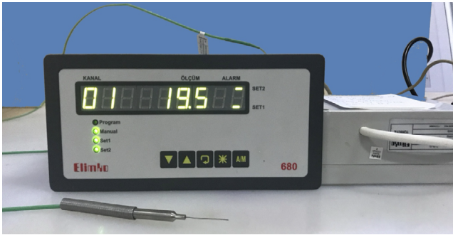
Figura 5. Termopar tipo K (Elimko, Turquía) y registradores de datos de diseño microcontrolador de entrada universal de la Serie E-680 (Elimko, Turquía).
