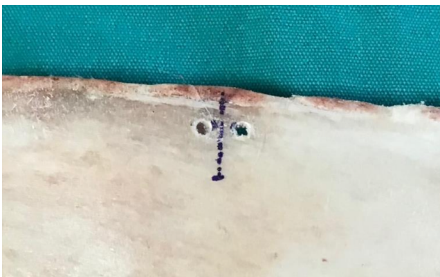
Figura 7. Las ranuras para colocar los termopares deben estar ubicadas a 1 mm de la línea de osteotomía.
