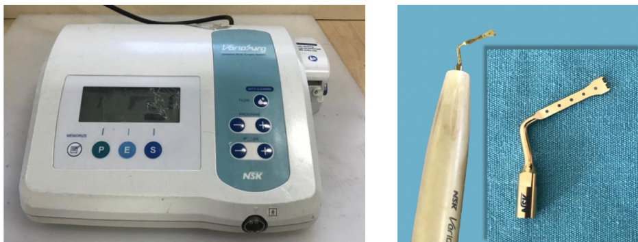
Figura 3. Osteotomía piezoeléctrica; dispositivo NSK-VarioSurg (Japón) con punta tipo "Sohn" de NSK (Japón).
