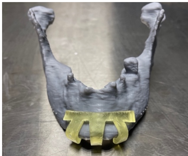
Figura 4. Guía de corte para mentón impresa en 3D.
