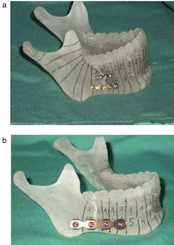
**Figura 2 – Prototipo mandibular de resina epoxi. a: Fijación con placas 2.0. b: Fijación con placa «lock».**
