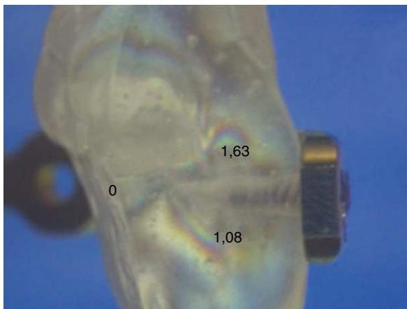
**Figura 5 – Sistema «lock». Nótese la escasa concentración de tensiones, y su localización en la zona que rodea al tornillo.**
