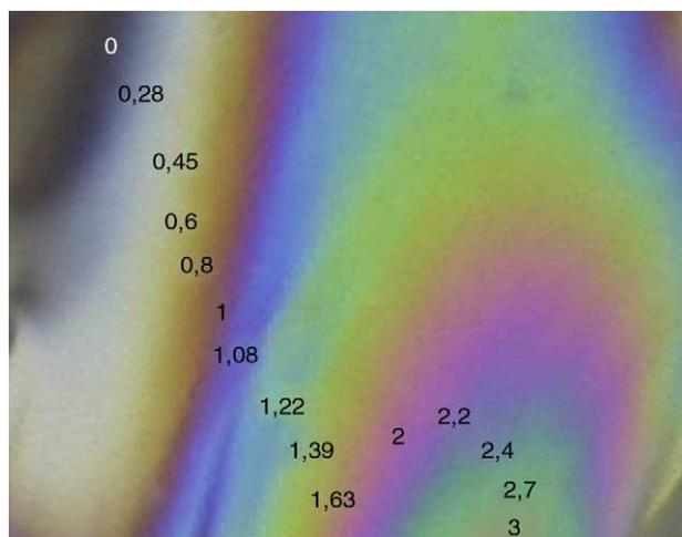
**Figura 1 – Espectro de isocromáticas, donde los diferentes números representan el «n» correspondiente a cada franja.**
