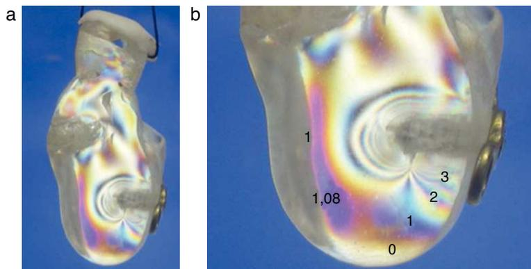
**Figura 3 – a Osteosíntesis convencional 2,0 mm. b. Nótese la importante concentración de tensiones, relacionadas con fuerzas de compresión, alrededor del tornillo y en ambas corticales óseas.**
